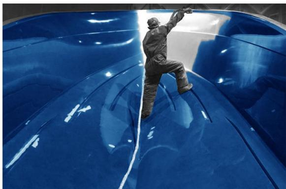
A combinação da resina poliéster com fibras de vidro cria um composto robusto, resistente à água e capaz de suportar as condições adversas do ambiente marítimo
